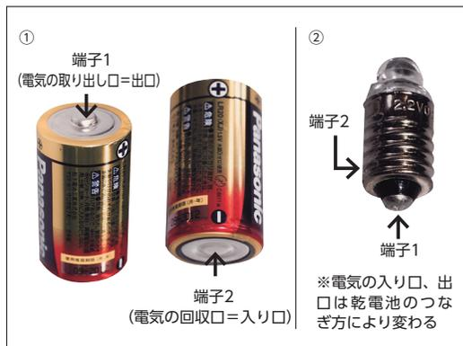
第2図 乾電池には、電気の出口と入り口の2つの端子がある。豆電球にも同様に、電気の入り口と出口の2つの端子がある
