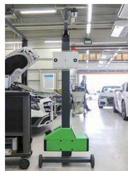
●指定ターゲットボード、ヘッドランプ調整用ツール
