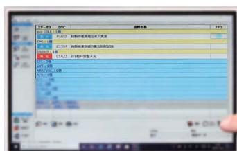
9 調整後、ステレオカメラ未完の故障コードとメーターにスマートアシスト故障と表示されるので全自己診断を実行
