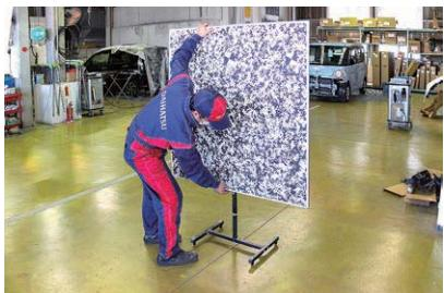
4 床面からSST模様下部までの高さ447mmの位置で設定されたスタンドにSSTを設置し、マーキングした2,500mm地点とSSTの中心点を合わせ、SSTの設置完了
